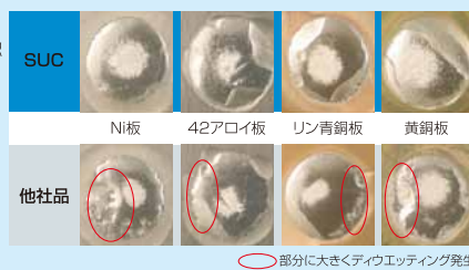
○部分に大きくディウエッティング発生
